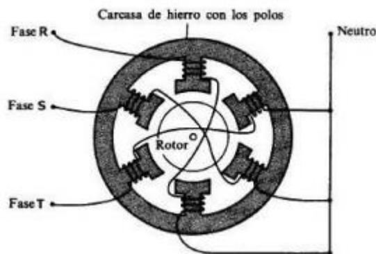
Fig. 3-3. Estator de dos polos [17].
