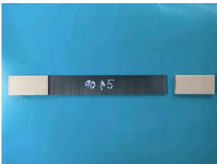
Figura 5-4. Probeta 90p5 rota por la zona del tacón
