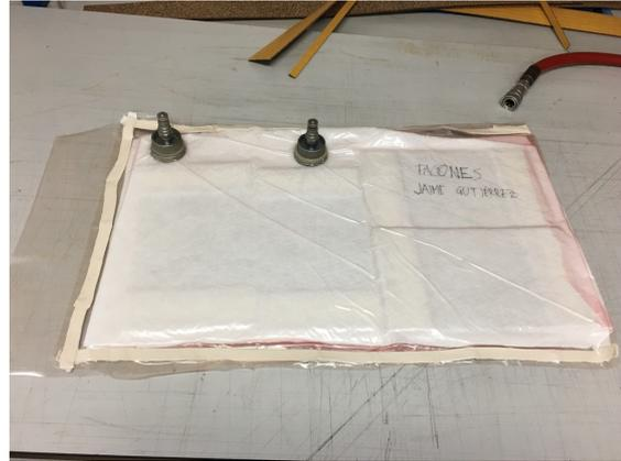
Figura 3-10. Bolsa de vacío para el curado del adhesivo de los tacones
