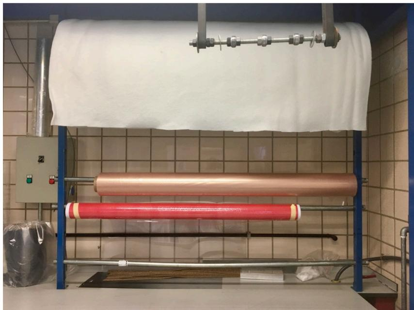
Figura 3-3. Rollos de material para la bolsa. De arriba a abajo: tejido aireador, plástico y teflón
