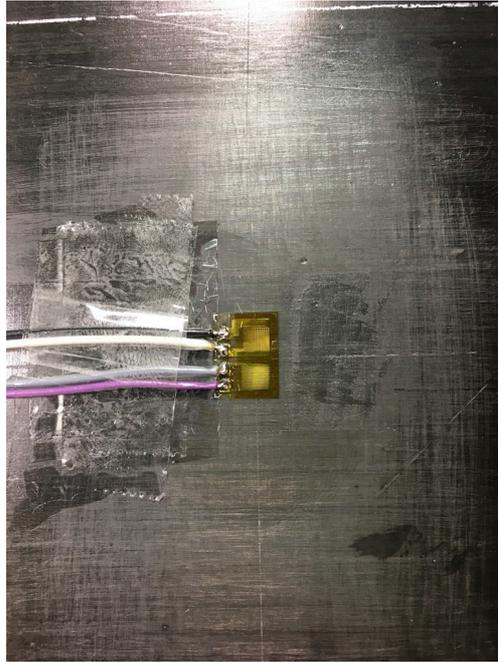
Figura 4-3. Banda extensométrica pegada sobre la probeta a ensayar
