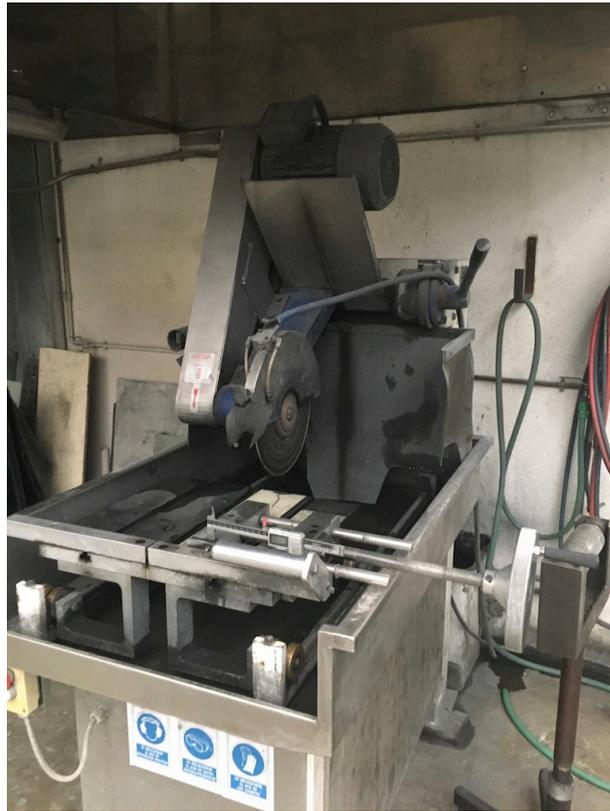
Figura 3-8. Máquina de corte empleada en el resanado y corte de las probetas
