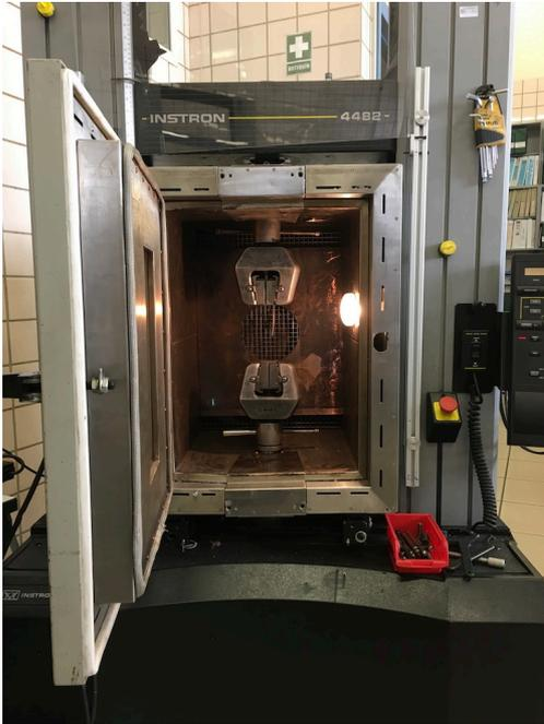
Figura 4-1. Máquina universal de ensayos con la cámara térmica instalada
