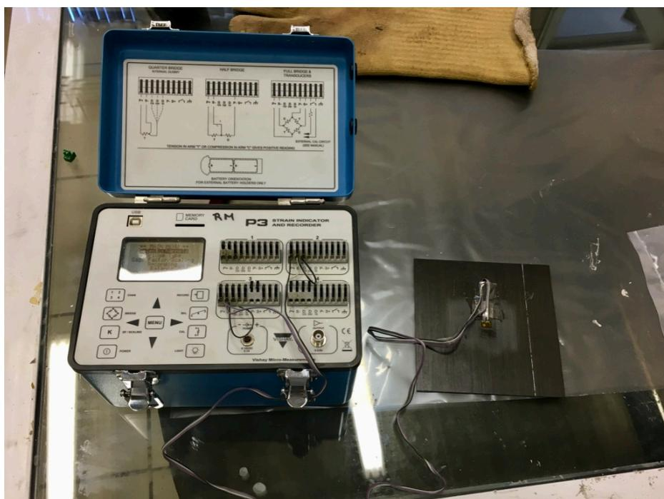
Figura 4-4. Banda extensométrica instalada y conectada al puente de Wheatstone para la medición de microdeformaciones
