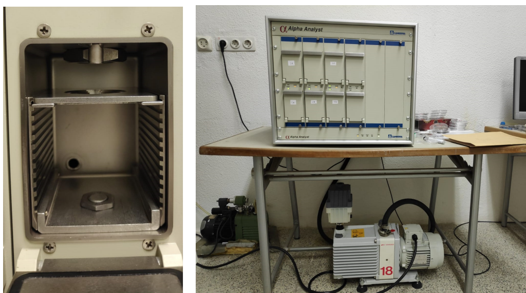
(a) Cámara con el detector PIPS. (b) Bomba de vacío y las 8 unidades espectrométricas.
