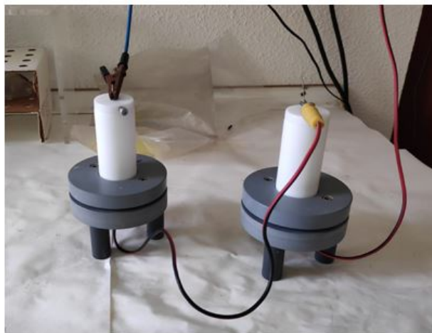
Figura 3.5: Electrodeposición de dos planchetas (conexión en serie).
