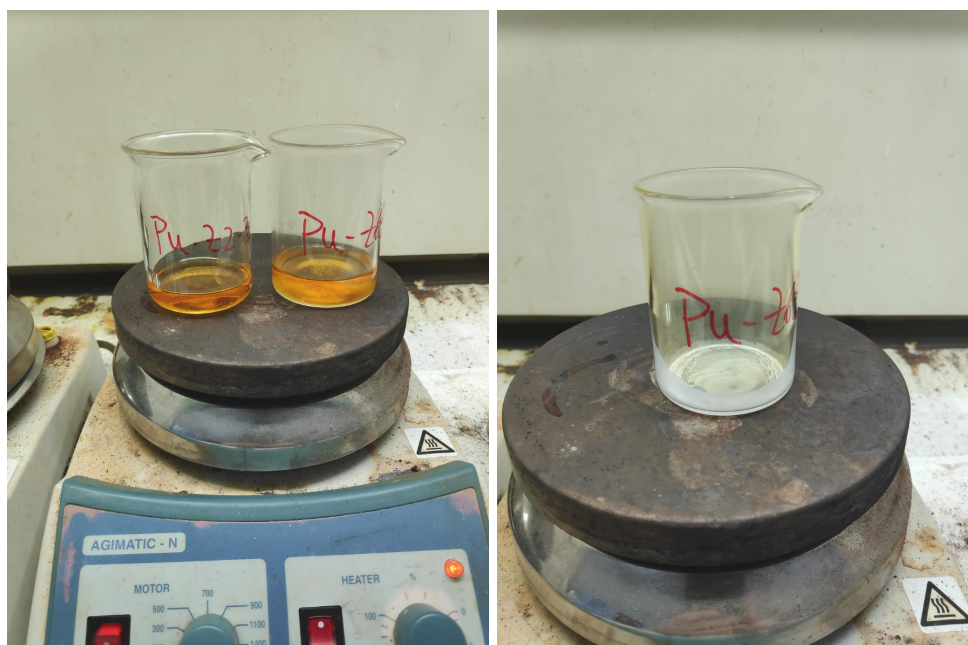
Figura 3.4: Preparación del electrolito llevándolo a sequedad, obteniéndose así la sal mostrada en la figura de la derecha.
