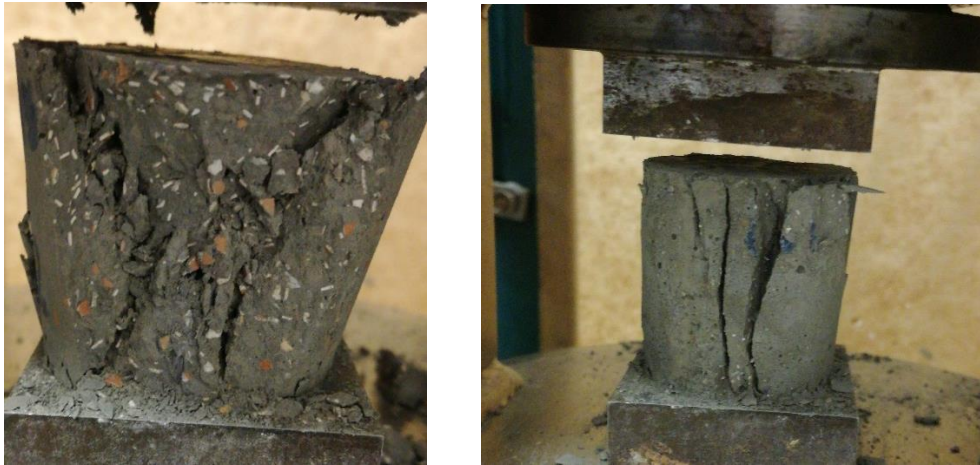
Figura 4.8. Probetas rotas tras el ensayo de resistencia a la compresión.
