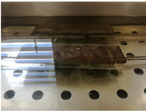
Figura 3.4. Muestras en los moldes de Chatelier dentro del baño termico de agua.
