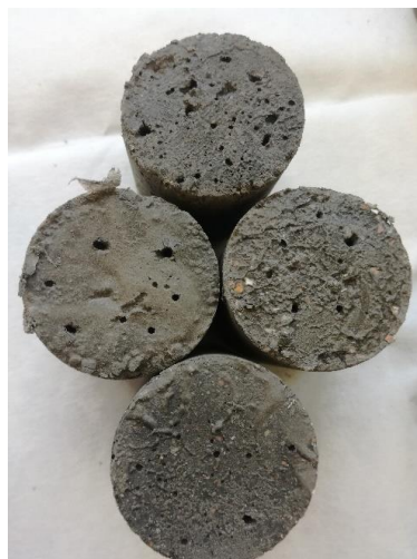
Figura 4.4. Muestras tras el ensayo de Vicat.
