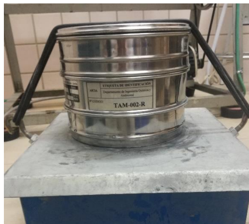
Figura 3.2. Placa vibratoria y tamices usados en el tamizado del residuo.
