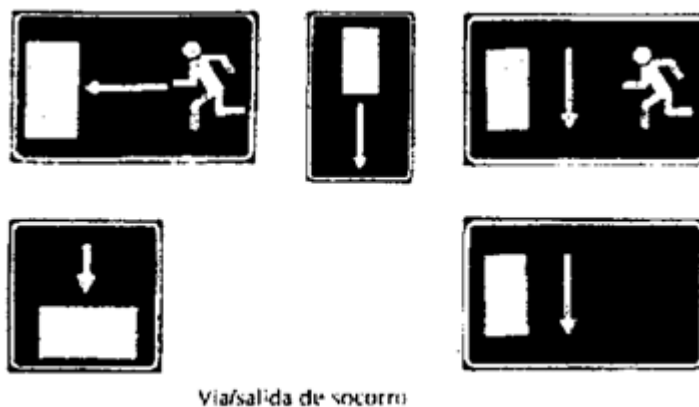
Figura 5-3. Señales de salvamento, vía/salida de socorro. Fuente: INSST.
