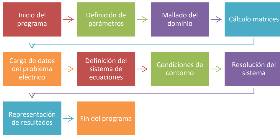
Figura 29. Lógica empleada en MATLAB para resolver el problema hidrodinámico
