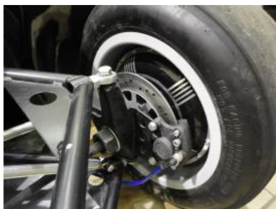
Figura 2-7. Motor eléctrico del vehículo FOX.
