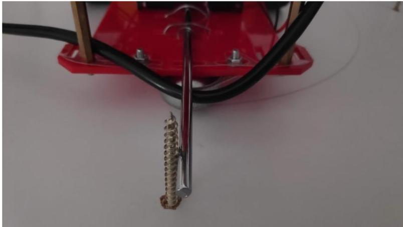
Ilustración 17. Tornillo y varilla para limitar el ángulo de giro.
