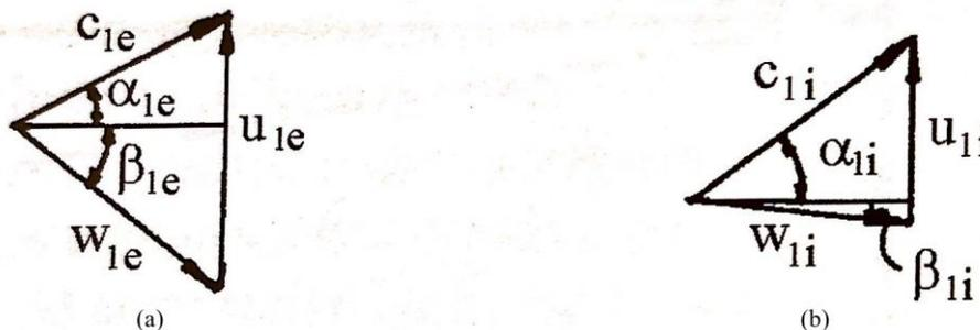
Figura 38 - Triángulos de velocidades a la entrada y en el tambor respectivamente
