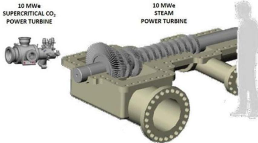
Figura 17 - Turbina de sCO<sub>2</sub> vs Turbina de Vapor. 10MWe.
