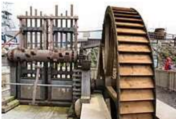
Ilustración 2-1 - Molino de pisón. Fuente: Wikipedia, Stamp mill
