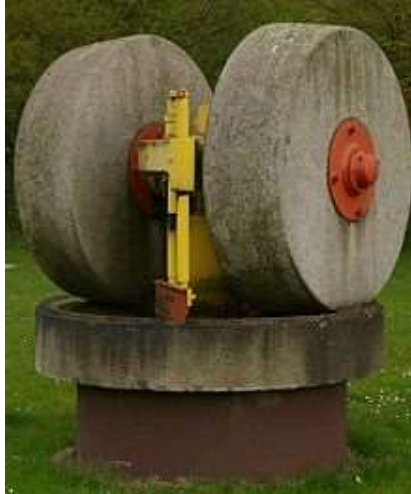
Ilustración 2-2 - Molino de rodillos vertical. Fuente: Wikipedia, Vertical roller mill
