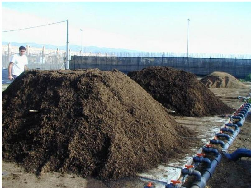
**Figura 28. Pila de compostaje con aireación forzada. Fuente: (Fernández López, 2011).**
