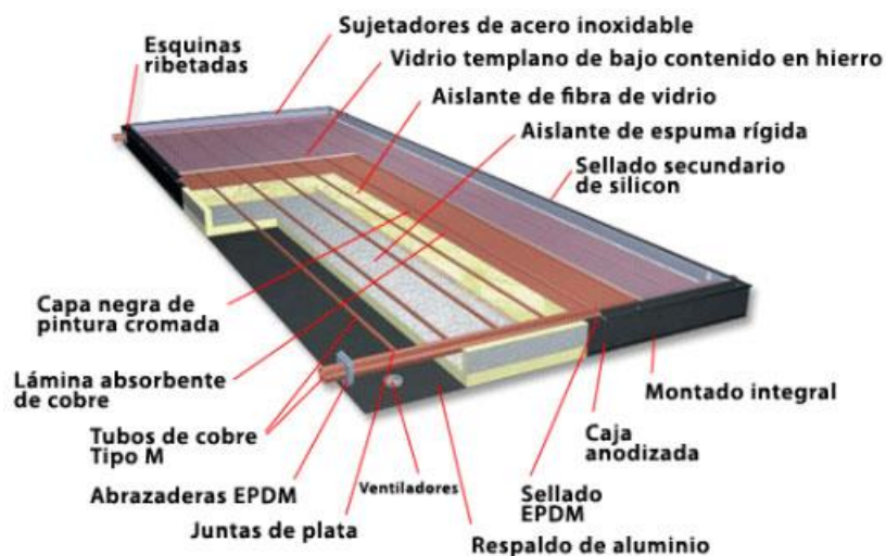
Figura 14. Partes de un captador solar protegido
