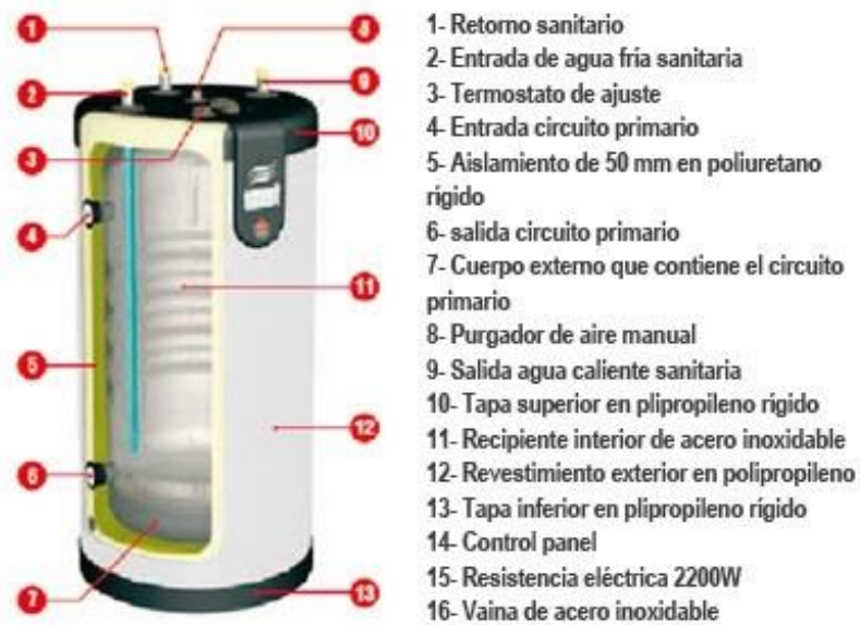
Figura 18. Partes de un acumulador solar
