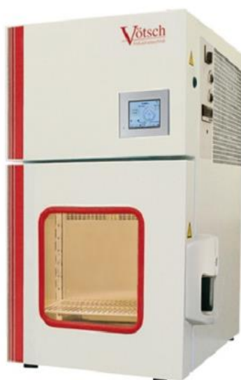
Figura 14: Cámara climática VCL 7006 de Vötsch.
