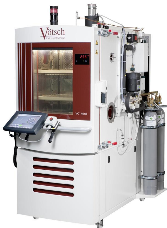
Figura 2: Cámara ambiental Vötsch VC 4018 para ensayos climáticos.
