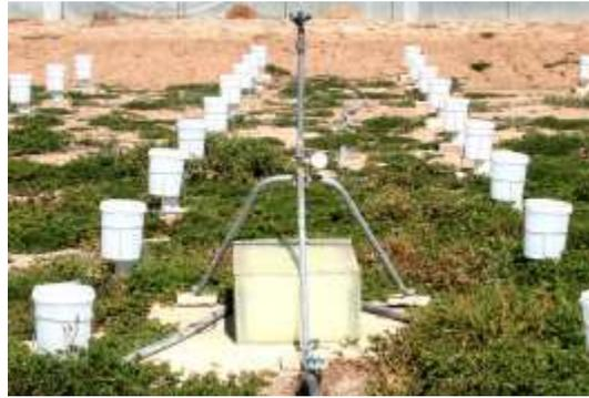
Figura 6. Apoyo del aspersor para el banco de prueba y SAD en una caja sellada.
