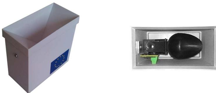
*Figura 9. Pluviómetro automático en la perspectiva de izquierda y derecha del indicador de lluvia planta sin la tapa superior.*
