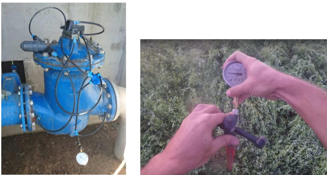
Figura 38. Detalle del control de la presión de ensayo a través de su fijación en el regulador (izquierda) y calibrada en el aspersor de manera simultánea (derecha).
