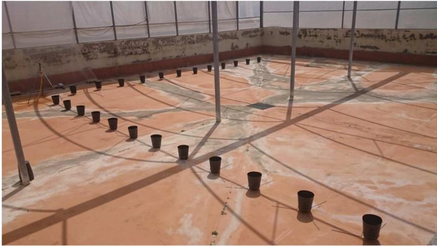
*Figura 13. Imagen del banco de ensayo radial sin viento.*
