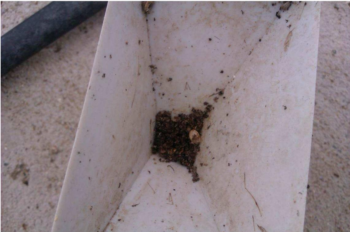
*Figura 26. Imagen de la obstrucción de los pluviómetros.*
