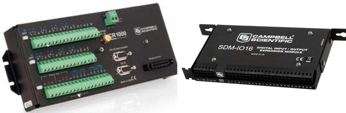
Figura 11. Imagen del DL CR1000 a la izquierda y del ME SDM-IO16 a la derecha
