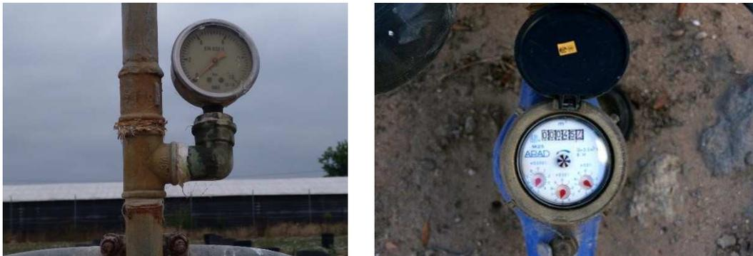
Figura 7. Elementos de medición y control del banco. A la derecha el manómetro y a la izquierda uno de los caudalímetros.
