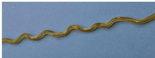
**Figura 12.** Filamento extruido a una temperatura superior, dando como resultado un color amarillo.
