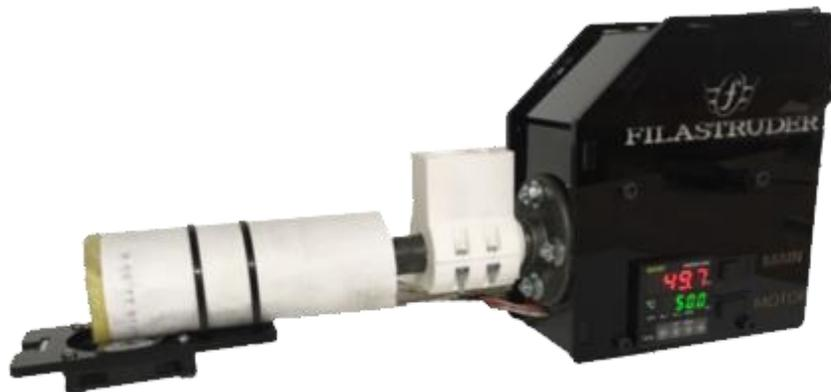
Figura 8. Equipo extrusor *Filastruder* (Fuente: [filastruder.com](http://filastruder.com)).
