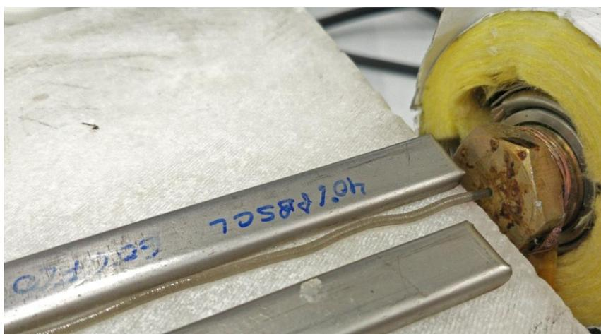
Figura 9. Extrusión de un filamento de polímero y fármaco por la técnica HME en el equipo Filastruder.
