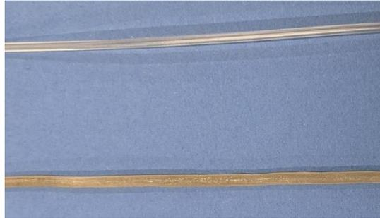
**Figura 11. Comparación entre el filamento de EG72D (arriba) y un filamento elaborado con la mezcla 70/30 (abajo).**
