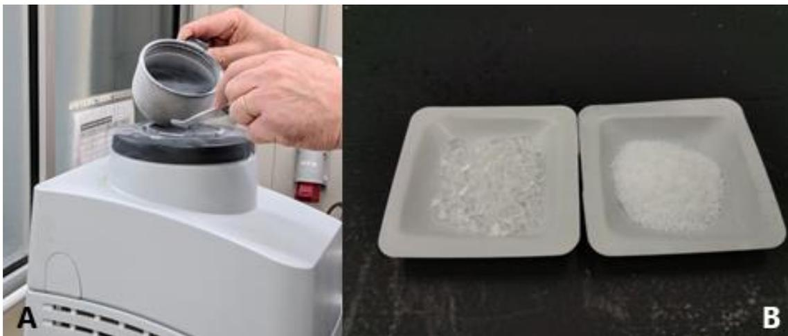
Figura 6. Proceso de pulverización del polímero (a). Antes y después de la pulverización de EG72D (b).
