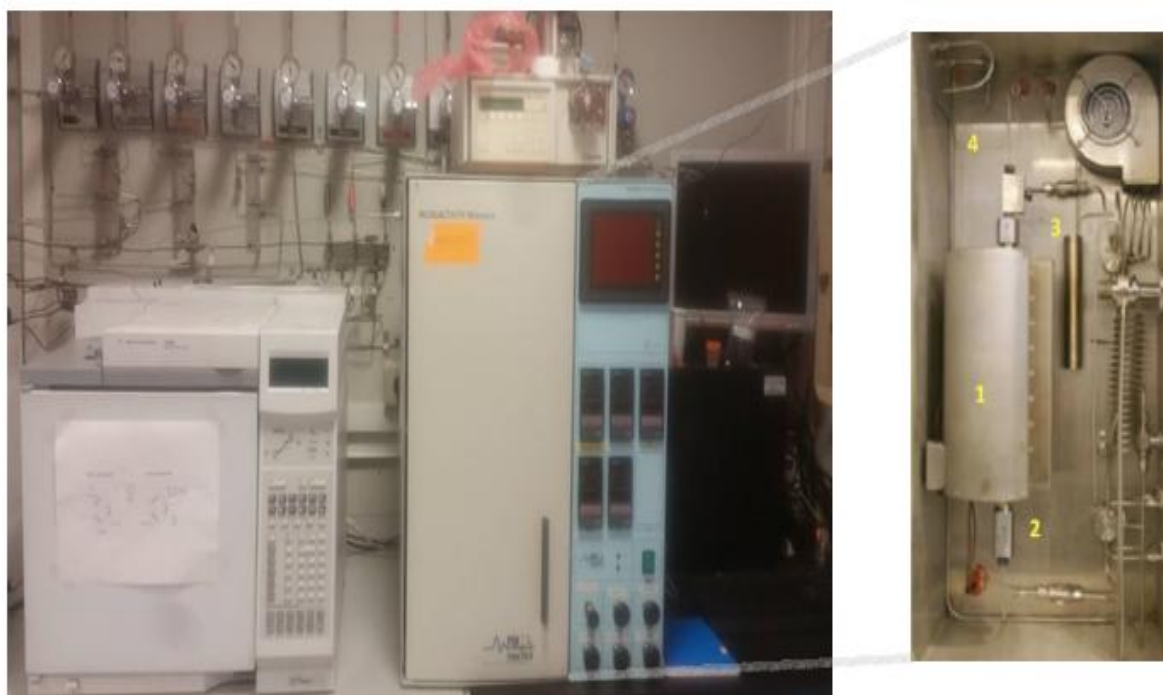
Figure II.9: Réacteur utilisé pour l'oxydation du CO.
