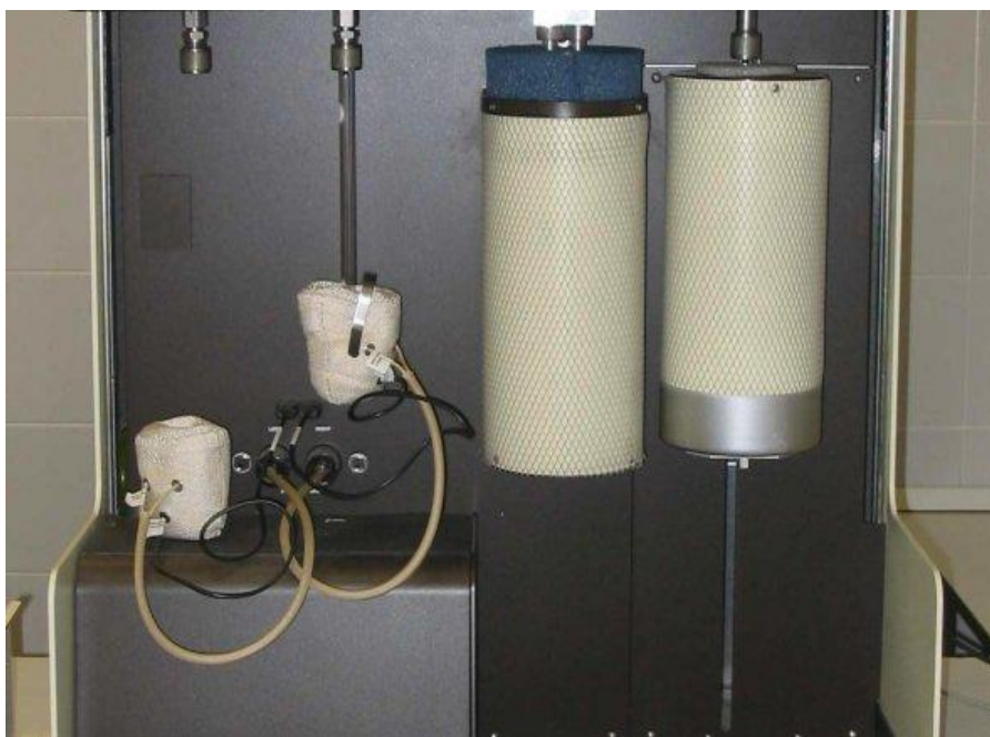
Figure II.16: Mesure de l'aire spécifique (BET).
