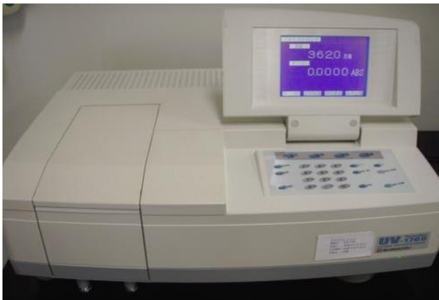
Figure II.13: Spectrophotomètre SHIMADZU UV-1700.
