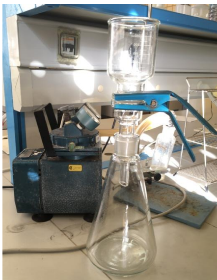
Figura 9. Equipo de filtración
