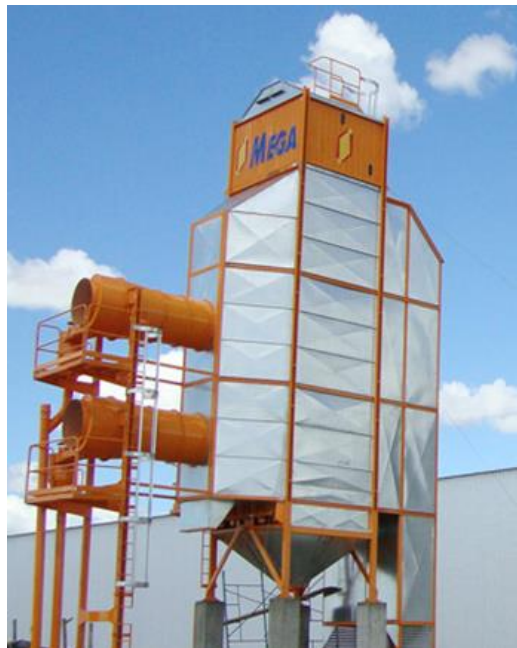
Figura 11. Secador-tostador industrial de malta
