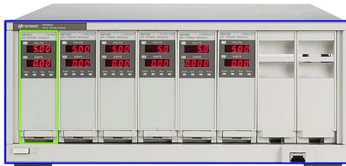
Figura 2-2. Módulo de energía dentro de una mainframe (MPS).
