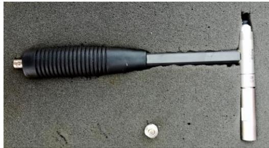
Figura 97. Hammer con la punta plástica negra colocada y la punta metálica en la zona central inferior
