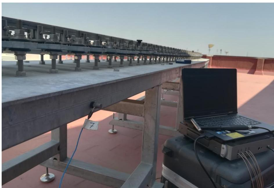
Figura 100. Posición del acelerómetro sobre la barra superior longitudinal
