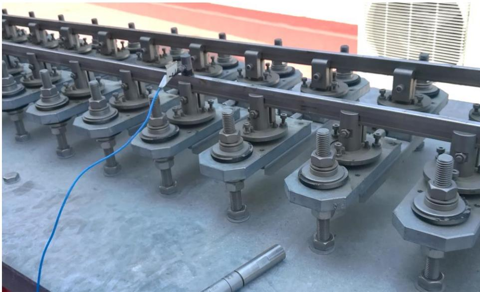
Figura 98. Posición del acelerómetro sobre el carril de las vías.
