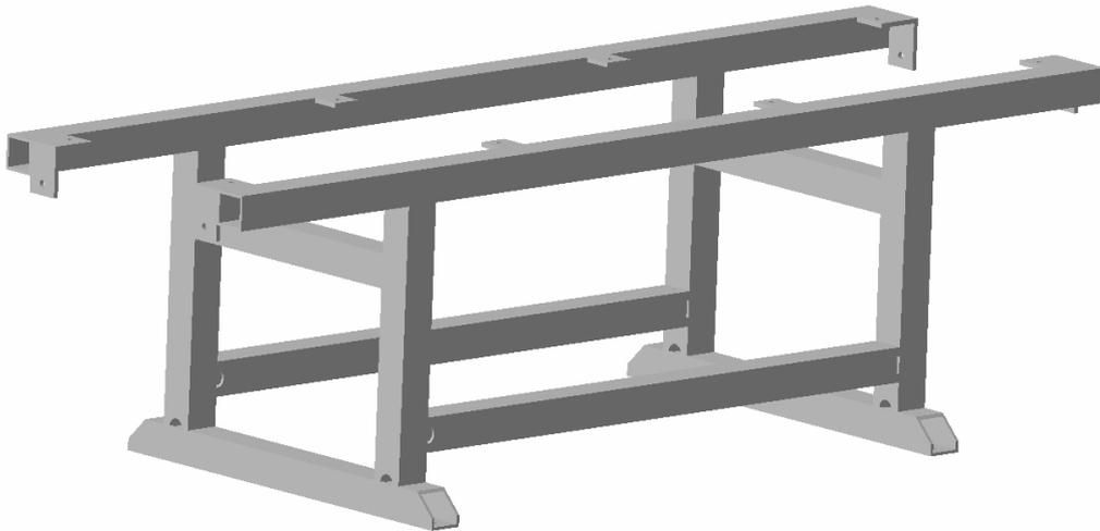
Figura 52. Estructura tubular de la mesa 30
