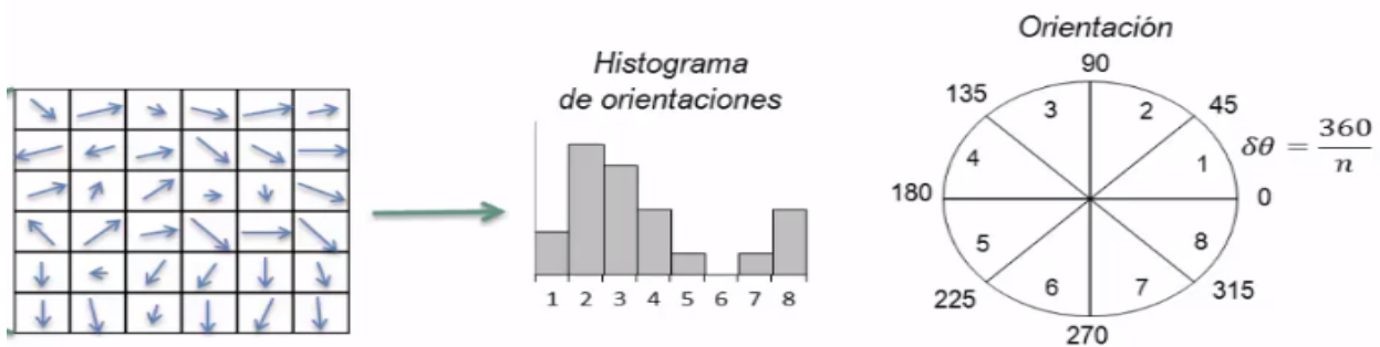
Figura 2.5.3: Construcción del histograma de orientaciones de los vectores gradiente.
