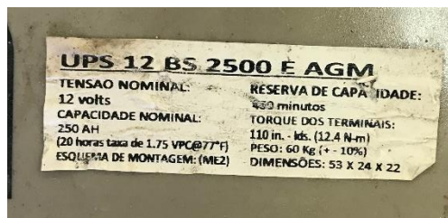
Figura 30: Ficha técnica batería.
