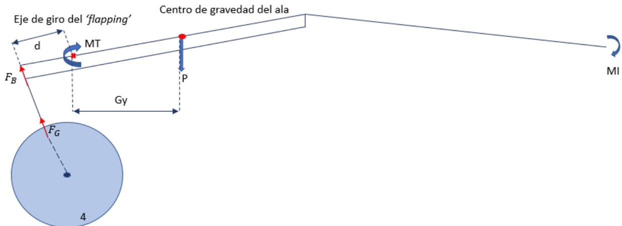
Figura 4-6. Esquema de las fuerzas sobre el ala y la biela izquierda
