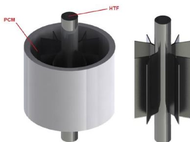
Figura 2-44. Esquema carcasa y tubo aleteado. (22)
