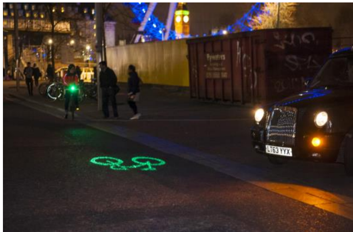
Figura 2-29. Sistema Blaze laserlight en funcionamiento. Fuente: www.bikecitizens.net .
