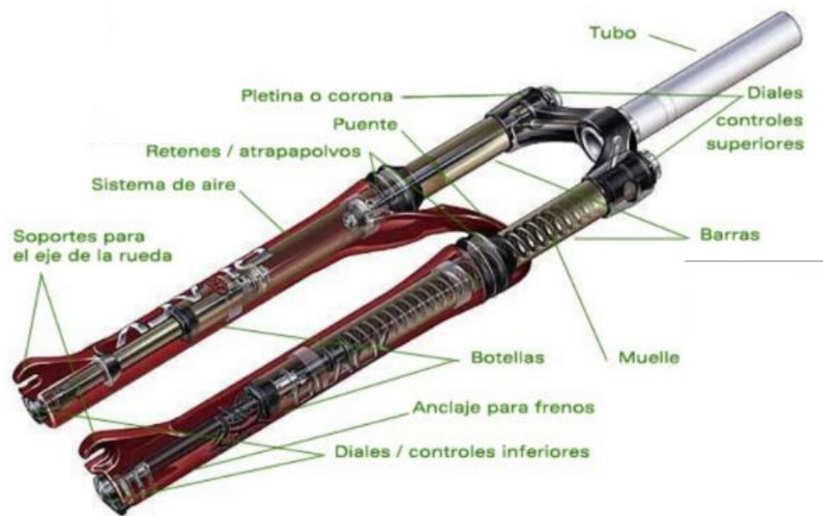
Figura 2-28. Partes de una horquilla con suspensión. Fuente: www.brujulabike.com .
