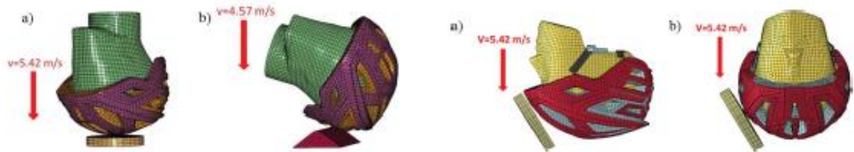
Figura 2-22. Modelos de impactos lineales y transversales realizados mediante elementos finitos.
