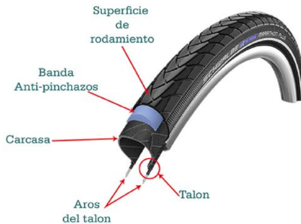
Figura 2-25. Estructura de un neumático de bicicleta actual. Fuente: Web de la Escuela de Mecánica de la Bicicleta.
