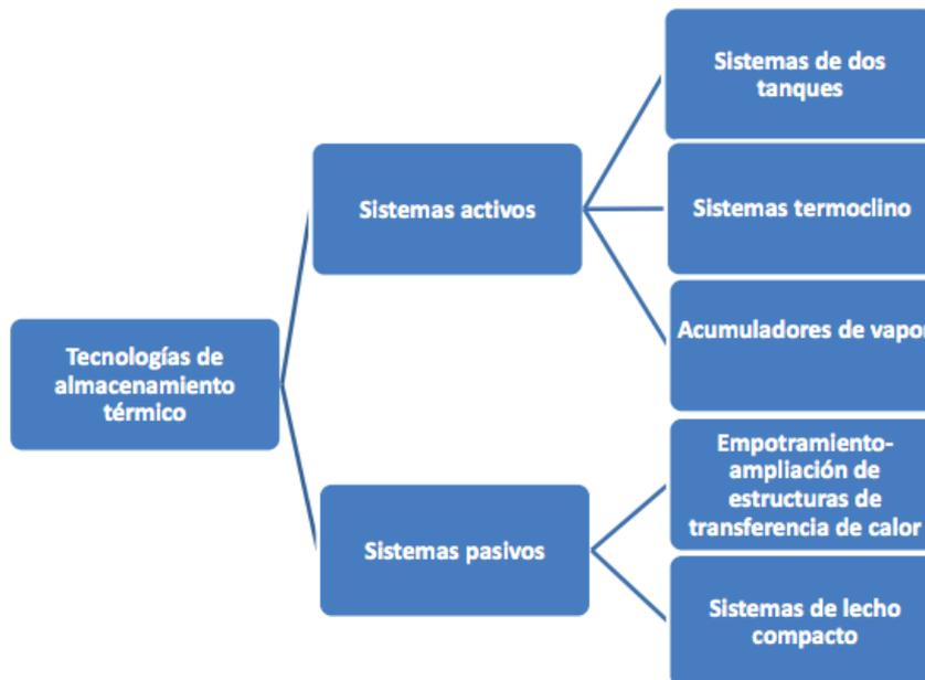
*Figura 3.* Tipos de sistemas de almacenamiento según el tipo de transferencia de calor al medio
