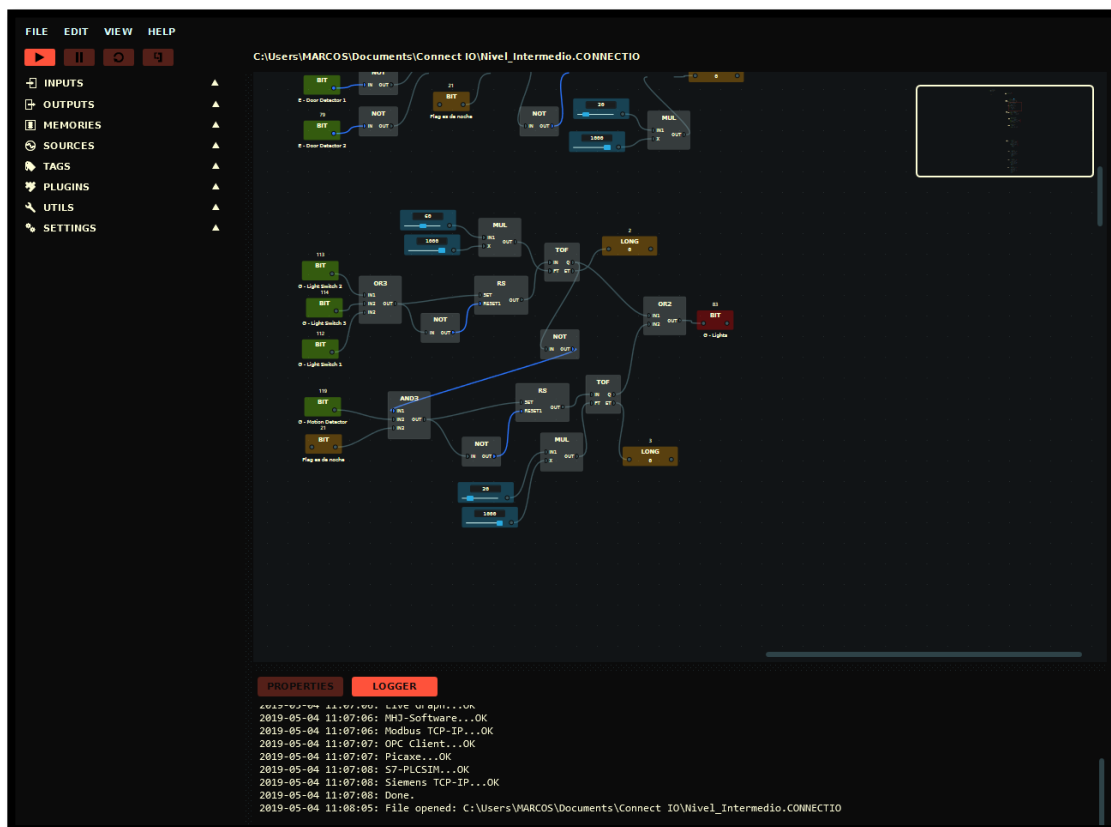
Figura 14. Ejemplo de la interfaz gráfica de Connect I/O
