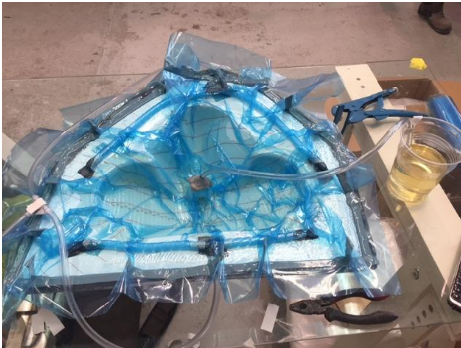
Figura 10-3: Ejemplo real del método por infusión en vacío
