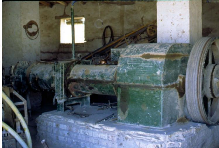
Fig. 32- Máquina humectante al vacío (mezcla y amasado)
