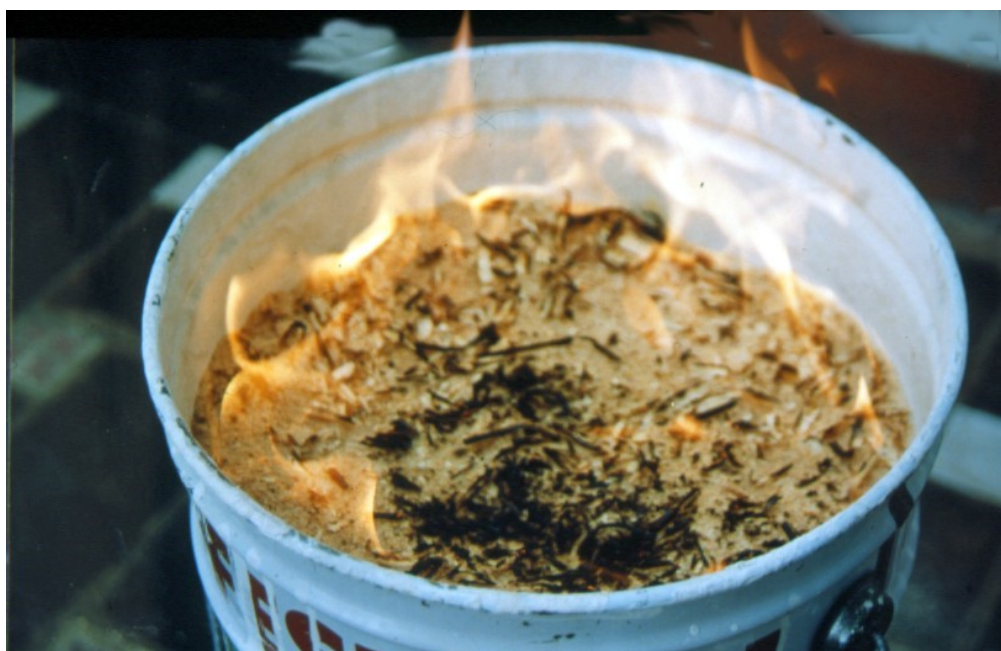
Fig. 42 – Cocción en atmósfera oxidante (bidón con serrín)
