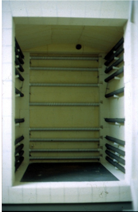
Fig. 39 - Interior horno eléctrico (hilos metálicos)
