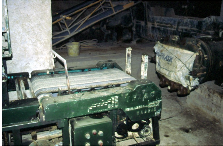
Fig. 35 - Cinta transportadora arcilla a máquina empaquetadora
