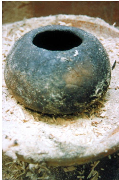
Fig. 40 – Pieza ennegrecida por atmósfera reductora
