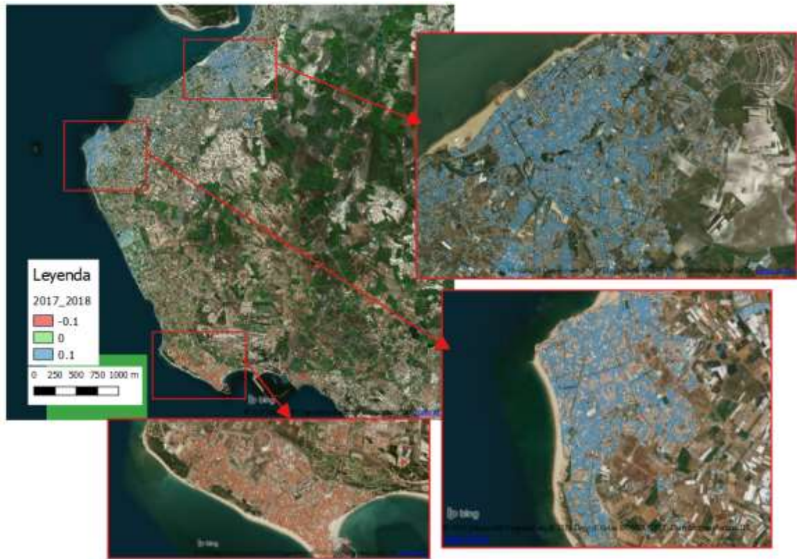
Figura 4.42 Diferencia de cota 2017-2018 - Detalle concentración de desplazamientos
