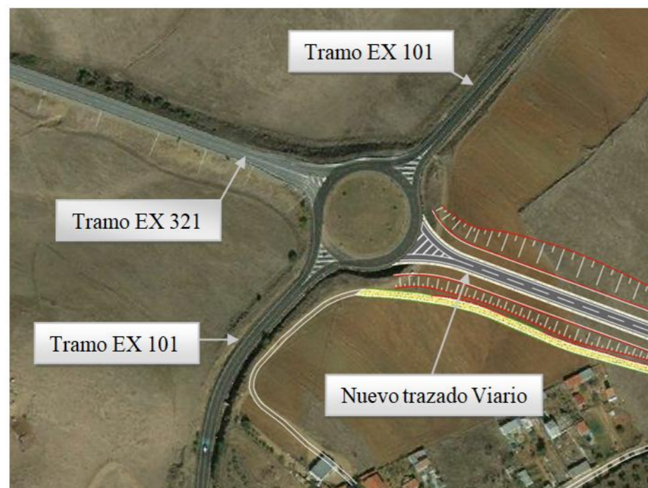
Ilustración 1. Comienzo de nuevo trazado viario, glorieta de confluencia entre viarios EX 321 y EX 101
