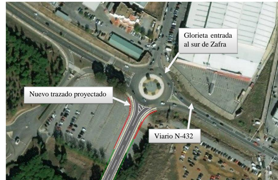
Ilustración 2. Tramo final del trazado viario, unión con glorieta de entrada al sur de Zafra
