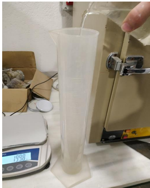
Figura 42. Preparación del agua de amasado
