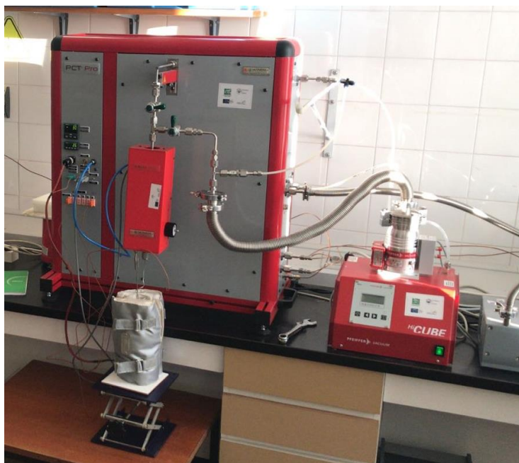
Figura 39. Equipo de adsorción de \text{CO}_2 utilizado con microdoser
