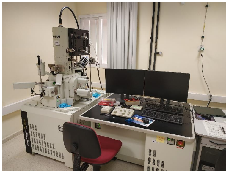
Figura 37. Equipo de microscopía de barrido utilizado
