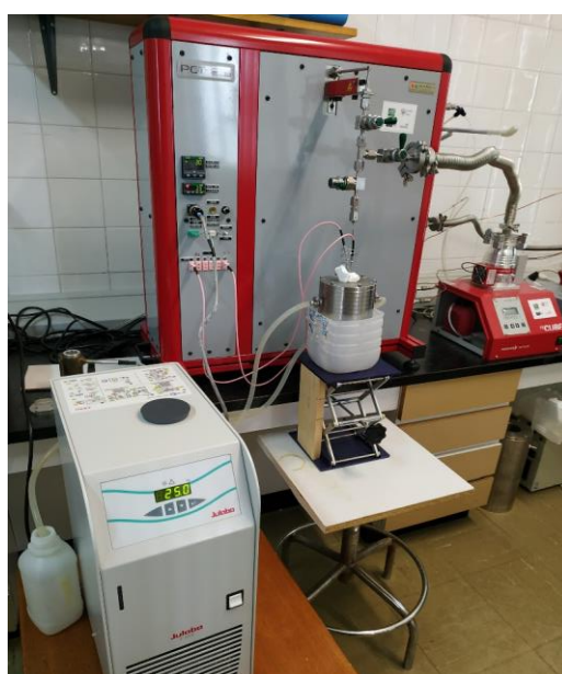
Figura 38. Equipo de adsorción de CO 2 utilizado y sistema de refrigeración
