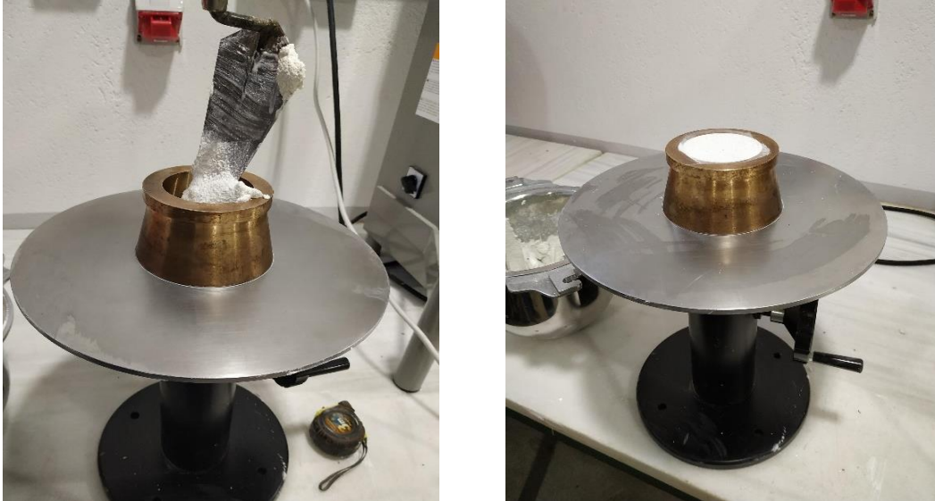
Figura 49. Relleno del molde troncocónico con mortero para realizar el ensayo de consistencia
