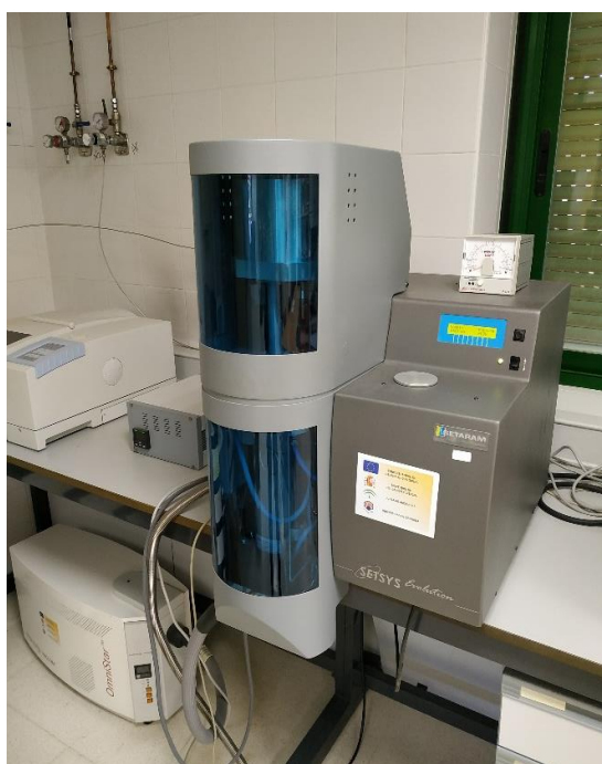
Figura 29. Equipo ATG-ATD utilizado
