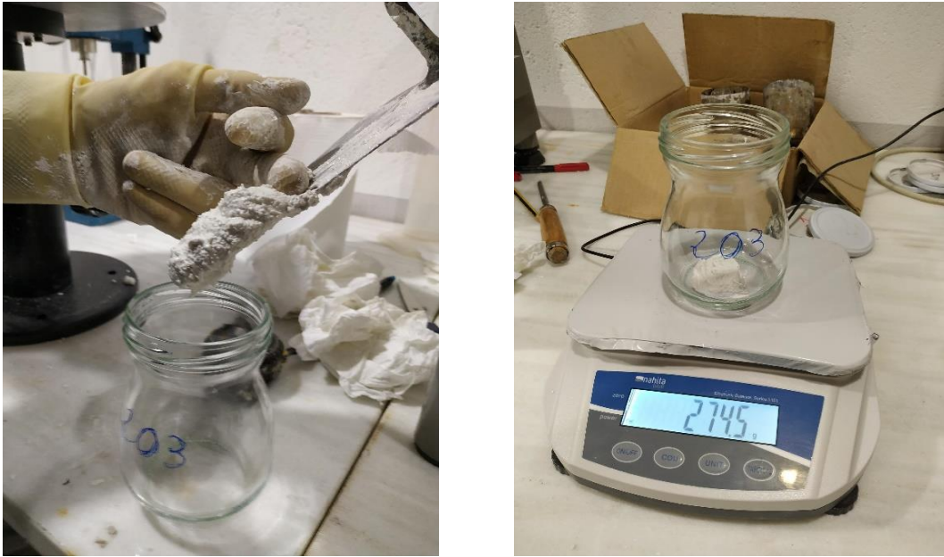
Figura 51. Toma de muestra y medición de masa para la determinación de la humedad de control
