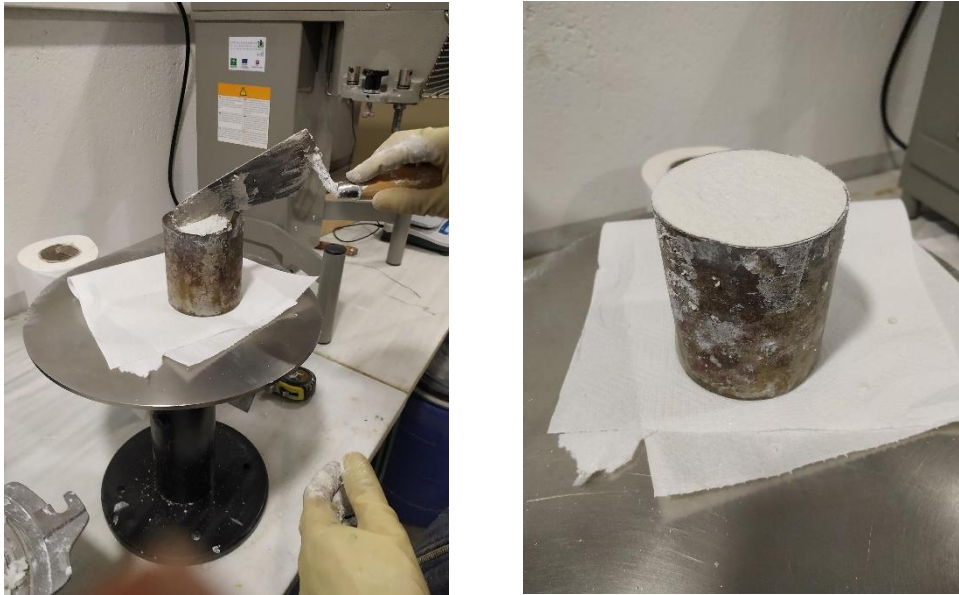
Figura 52. Relleno de molde con mortero para el ensayo de trabajabilidad
