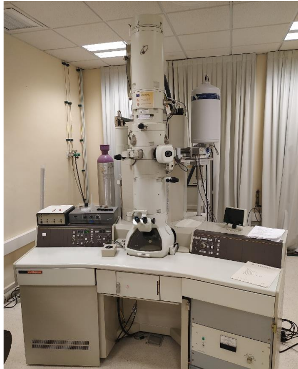
Figura 36. Equipo de microscopía de transmisión utilizado
