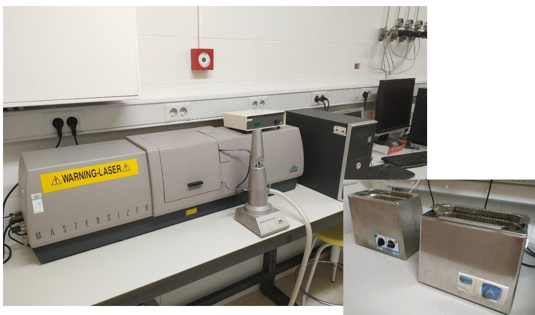
Figura 35. Equipo de tamaño de partícula utilizado y detalle del instrumento de ultrasonidos
