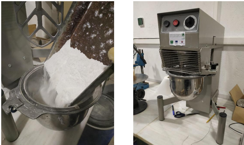
Figura 44. Mezcla del mortero seco, hidrotalcita y agua y detalle de la amasadora utilizada
