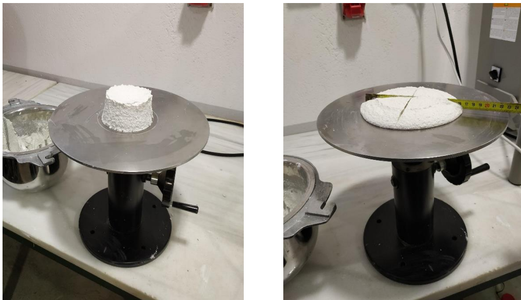
Figura 50. Imágenes tomadas durante el ensayo de consistencia
