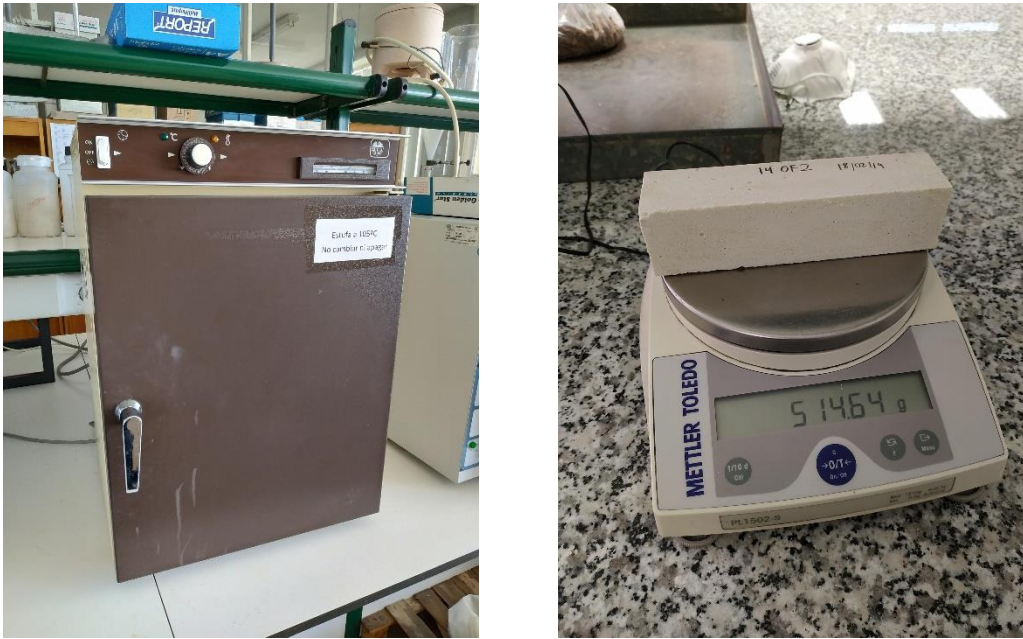
Figura 57. Estufa de secado a 110 °C y medición de masa en el ensayo de densidad aparente seca
