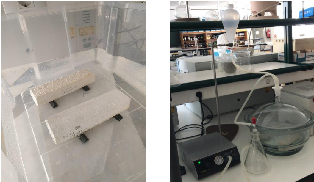
Figura 58. Inmersión de las probetas en agua y equipo de vacío para la determinación de la porosidad
