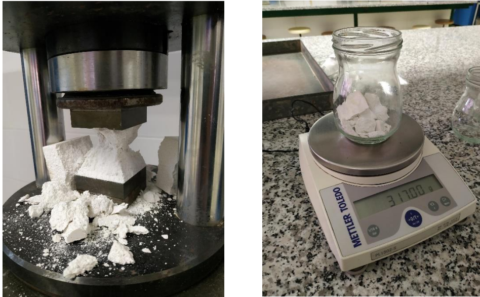
Figura 56. Restos de mortero después del ensayo a compresión y su uso en la determinación de la humedad
