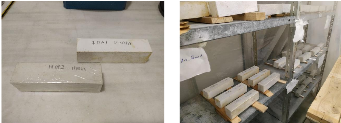
Figura 47. Probetas en film y aire después de desmoldar y espacio de curado
