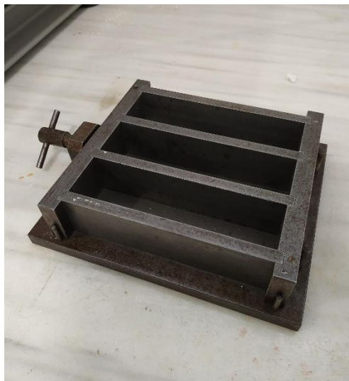
Figura 45. Detalle de un molde con tres compartimentos para probetas de mortero
