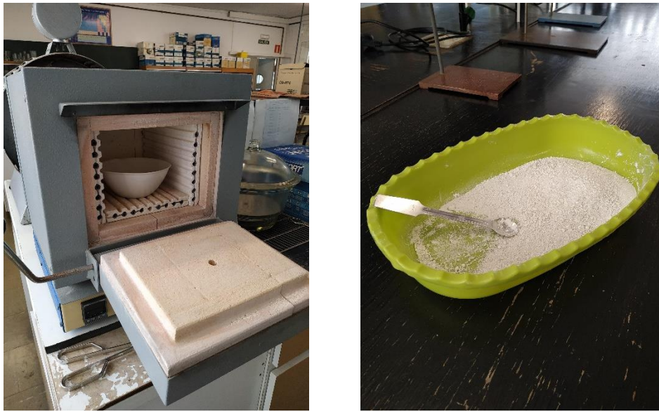
Figura 43. Calcinación de la hidrotalcita en mufla
