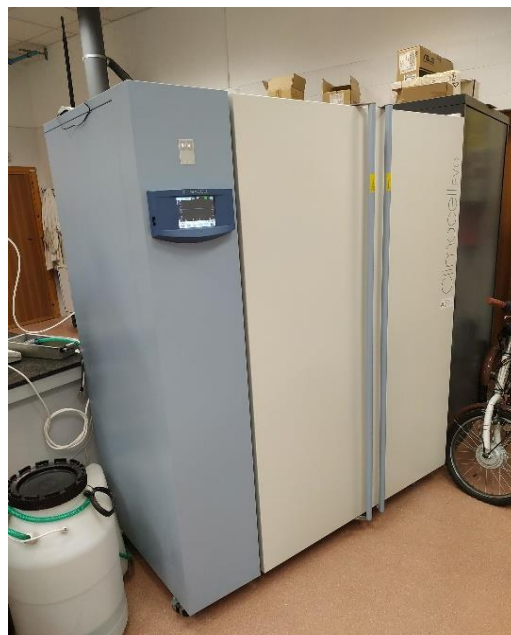
Figura 48. Cámara de carbonatación utilizada
