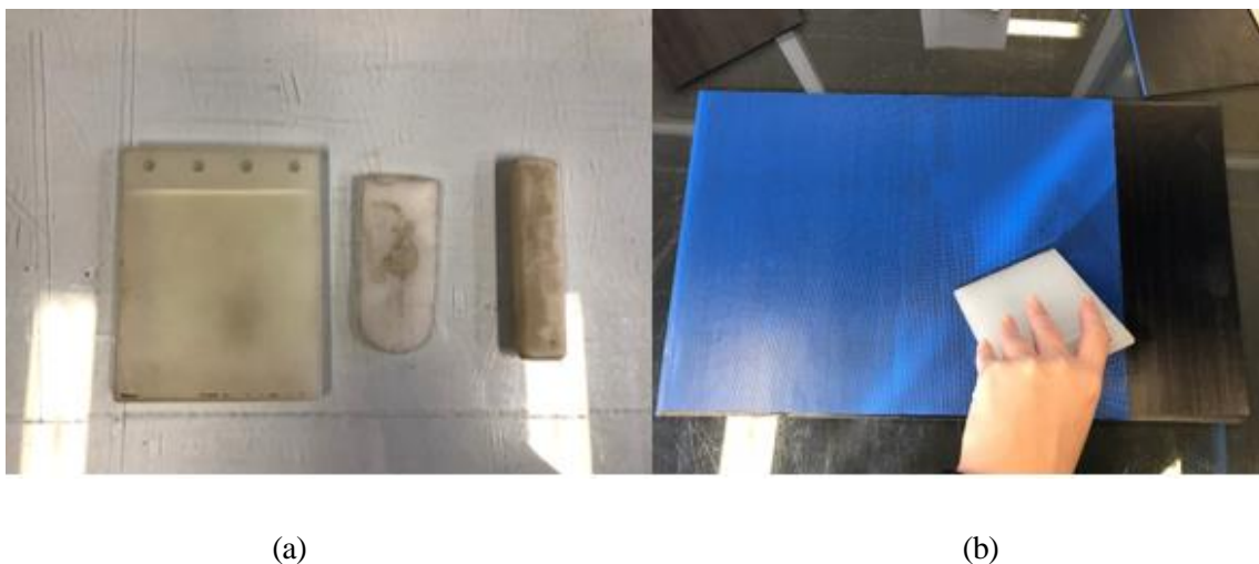
Figura 2-3. (a) Espátulas empleadas en el apilado manual; (b) aplicación de la presión manual.
