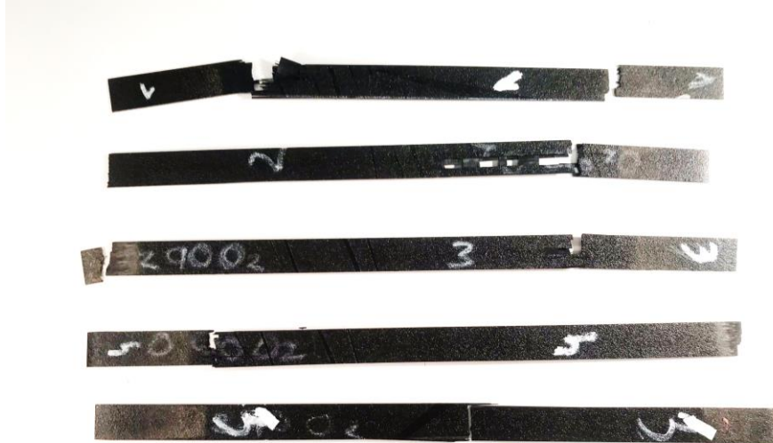
Figura 5-2. [0 2 ,90,0 2 ]: Probetas ensayadas hasta rotura.
