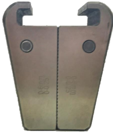
Figura 4-5. Mordaza empleada en los ensayos de tracción.
