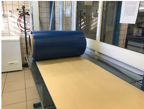
Figura 2-1. Rollo del material compuesto empleado en la fabricación de las probetas.
