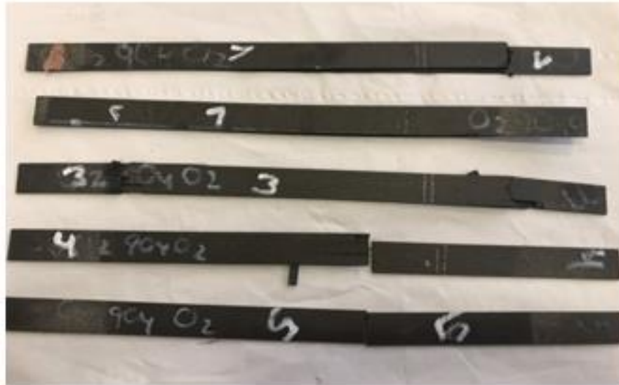
Figura 5-4. [0 2 ,90 4 ,0 2 ]: Probetas ensayadas hasta rotura.
