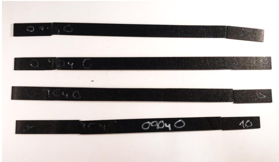
Figura 8-1. [0,90 4 ,0]: Probetas ensayadas a primer aviso sonoro. Rotura.
