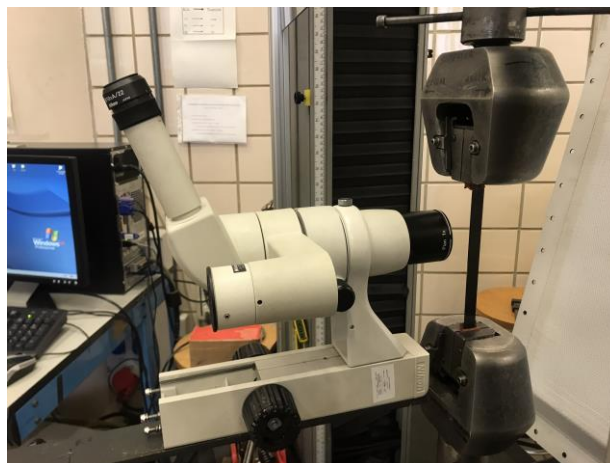
Figura 4-2. Muestra de la lupa colocada para visualizar in situ la aparición de la primera grieta durante el ensayo.
