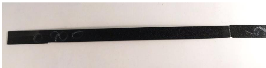
Figura 7-1. [0,90,0]: Probeta 5. Ensayo al 80% de carga. Rotura.
