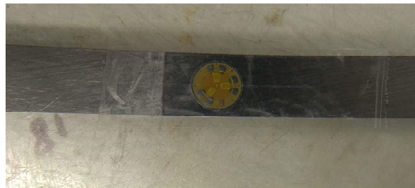
Figura 3-11 Colocación de la banda
