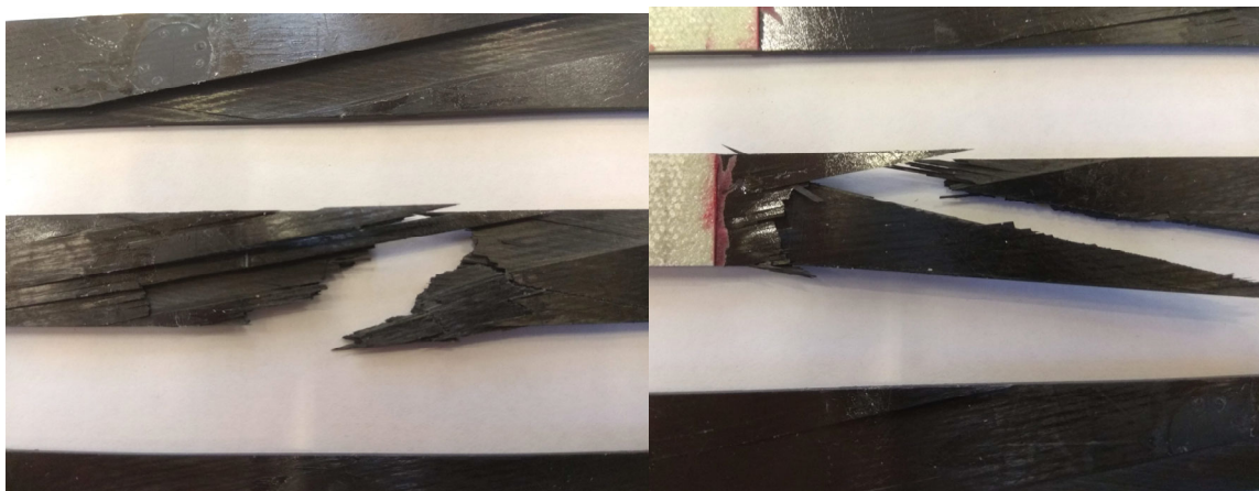
Figura 4-9 Detalle rotura probetas de 8 capas
