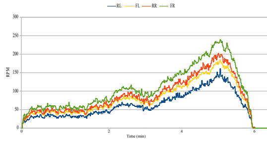
Figura 19: Velocidad de los cuatro motores (rpm), Rueda trasera izquierda (RL), Delantera izquierda (FL), Trasera derecha (RR) y Delantera derecha (FR).
