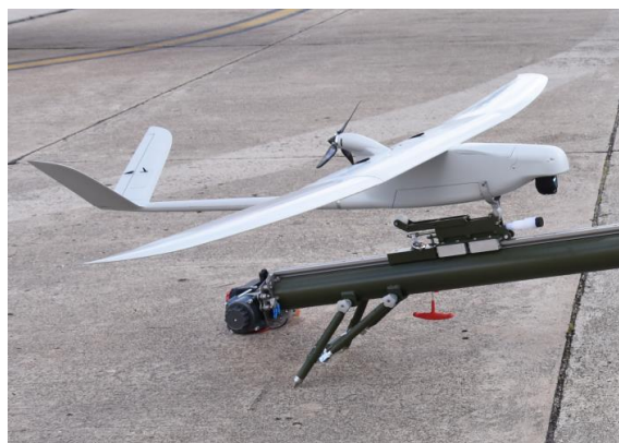
Figura 3. Despegue UAV con sistema de catapulta [3]
