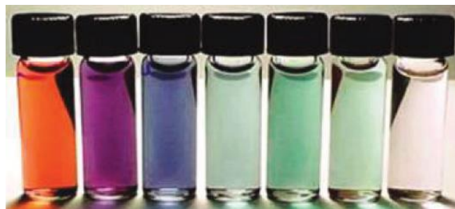
Figura 11. Disoluciones de QDs de SiO 2 /Au con diferente tamaño de cubierta, por lo que tienen colores de fluorescencia distintos. Ilustración de (Reviews and Rourkela, 2011).
