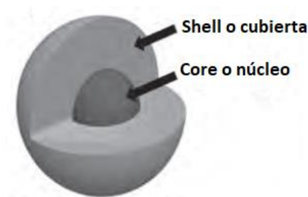
Figura 2. Representación de la estructura general de una nanopartícula core-shell . Ilustración adaptada de (Arroyo et al., 2014).
