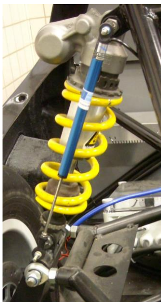
Figura 2.3: Potenciómetro en el amortiguador del FOX [5]
