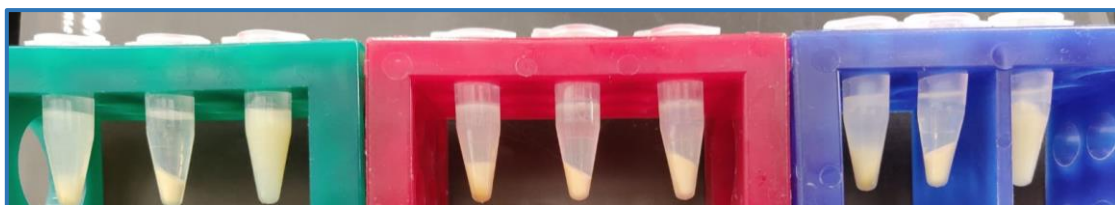
Figura 18: Muestras de los distintos lotes elaborados tras el proceso de centrifugación, ordenados del 1 al 9. Se puede observar como en los lotes 3 y 9 liposomas no precipitaron, lo cual hizo imposible la separación del sobrenadante, necesaria para la determinación de la EE.
