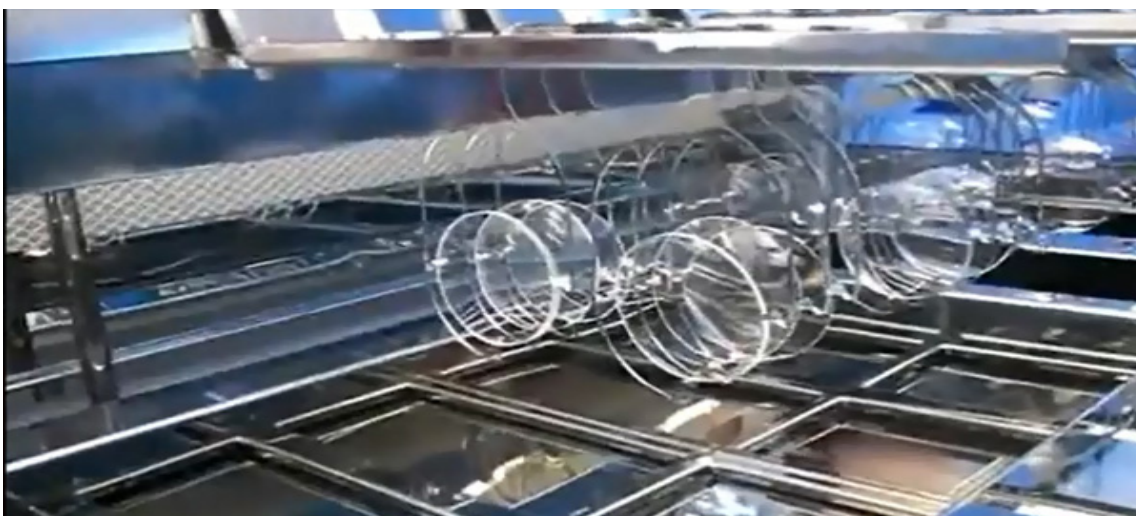
Figura 2. Método de dip-coating industrial con lentes oftálmicas (OpticiansClub, 2019)
