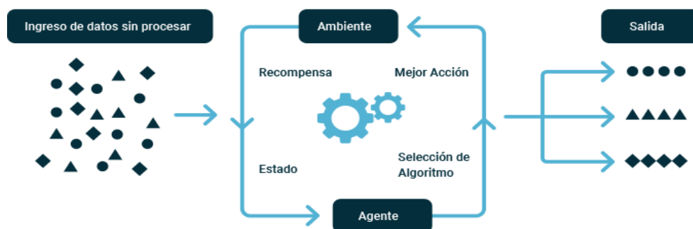
Figura 4. Diagrama de flujo de aprendizaje por refuerzo. El algoritmo premia o penaliza durante la construcción del modelo en función de su respuesta.
