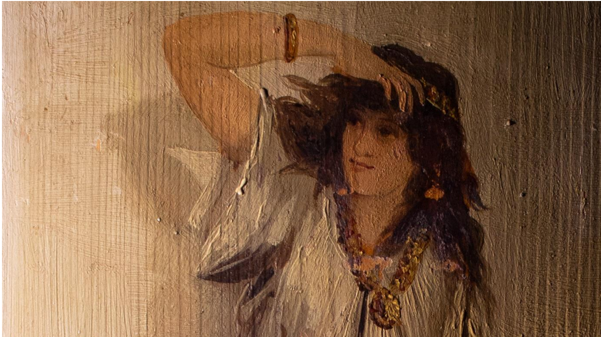
Figura 8 Ejemplo de luz rasante donde podemos observar la veta del soporte de madera y las lagunas en la capa pictórica.
