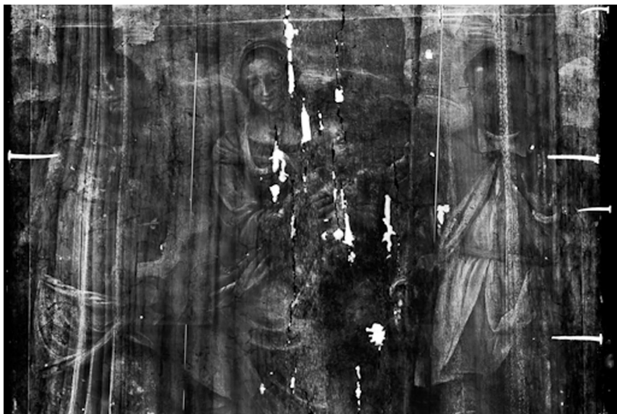
Figura 23 Toma radiográfica realizada por el equipo de documentación técnica del IAPH, Virgen con el Niño, San Sebastián y San Roque, de Bernardino Luini. Utrera. Se puede ver con claridad los elementos metálicos en el interior del soporte.
