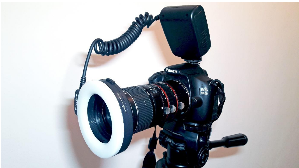
Figura 5 Configuración de la cámara para toma de imágenes macro. De izquierda a derecha: flash anular, objetivo, tubos de extensión y cuerpo de la cámara.
