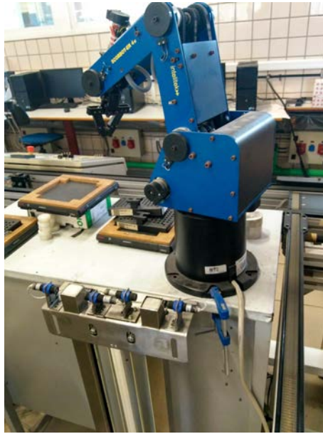
Figura 1.7 Brazo robótico Scorbot y alimentador de piezas.
