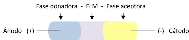
**Figura 1.27.** Esquema del dispositivo de  $\mu$ -EME.
