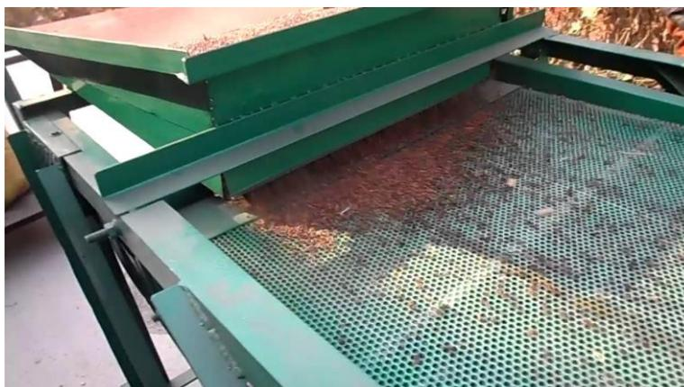
**Figura 40.** Sistema industrial para la separación de semillas a partir de orujo de uva (Fuente: *The GRAPEVINETM Magazine*).
