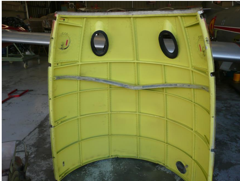
Figura 52. Parte anterior del fuselaje. Largueros.
