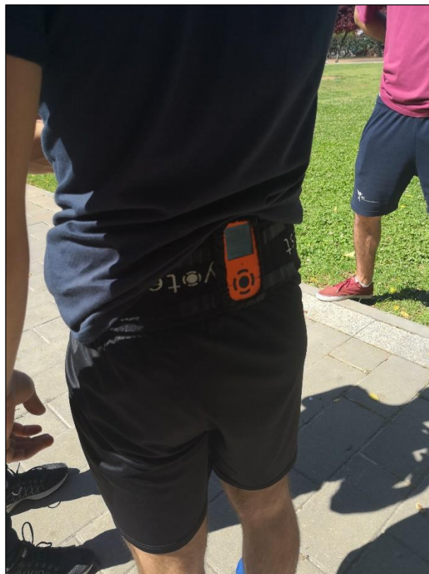
Ilustración 11. Colocación del acelerómetro Myotest.
