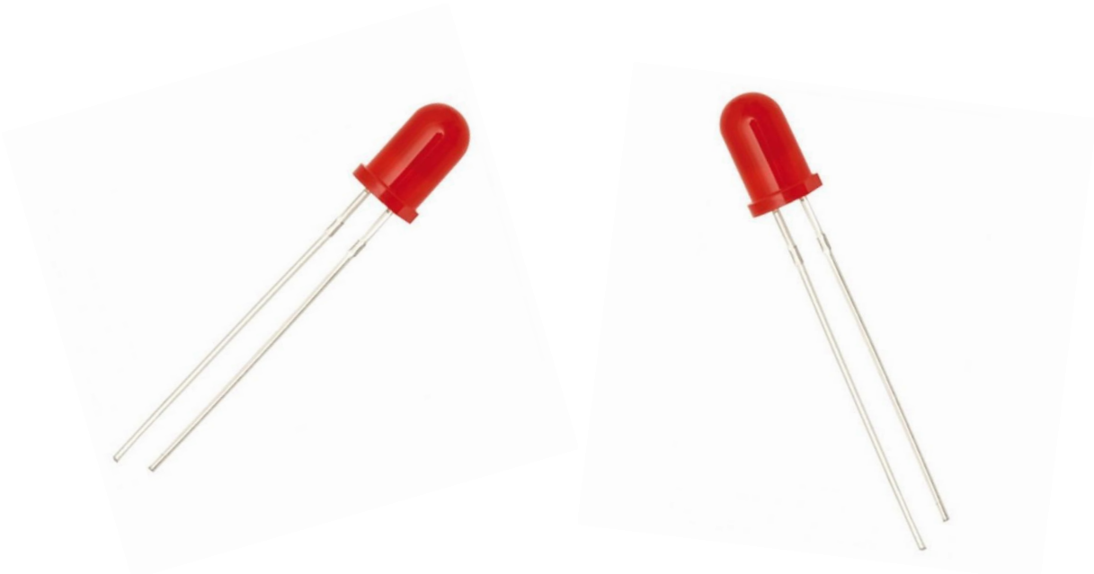
Figura 4:11 LEDs que serán incluidos en la parte trasera del robot.
