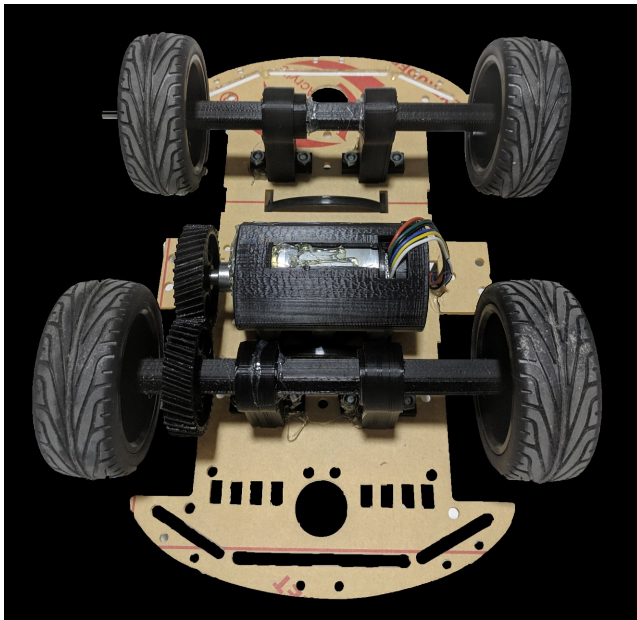
Figura 4:18 Robot terminado. Vista de los bajos.
