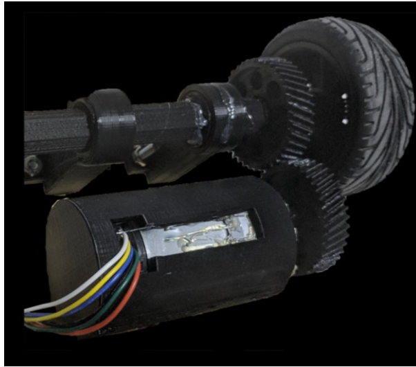
Figura 4:19 Motor, engranajes y eje.
