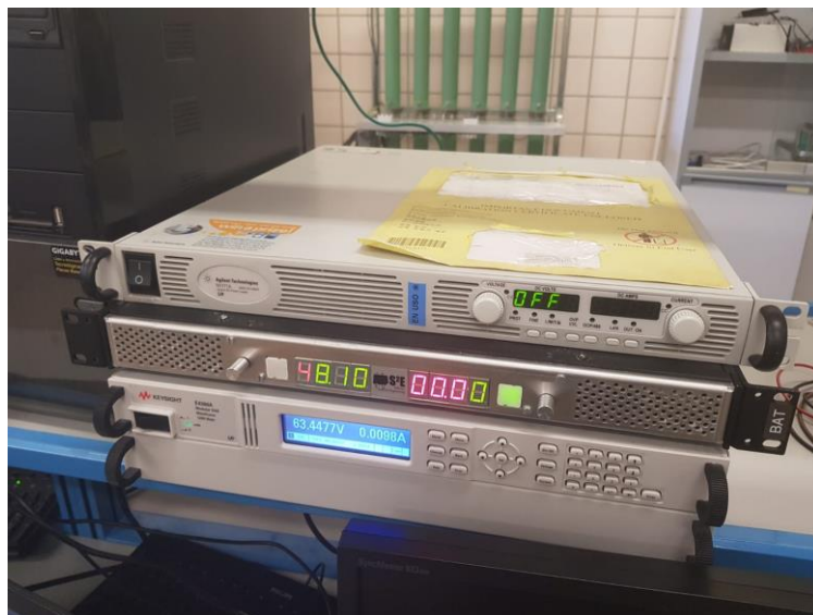
Figura 5-1. Fuentes utilizadas en el equipo. De arriba a abajo: fuente de tensión, batería y emulador de PV.
