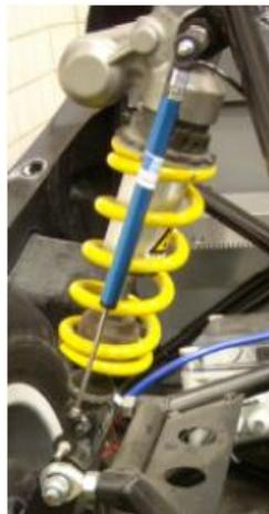
Figura 3-4: Potenciómetro lineal en amortiguación
